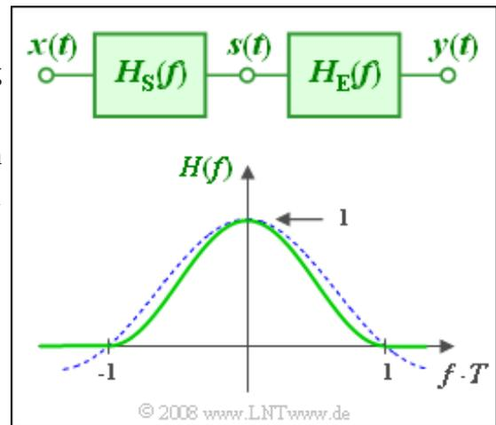
Anzumerken ist, dass die äquivalente Bandbreite  $\Delta f = 1/T$  betragen soll. Damit ist die äquivalente Dauer  $\Delta t$  der Impulsantwort ebenfalls  $T$  und man erhält:
