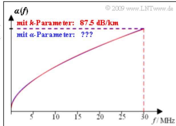
Insbesondere zur Berechnung von Impulsantwort und Rechteckantwort ist es von Vorteil, auch für die Kupfer-Doppeladern die zweite Darstellungsform mit den Kabelparametern  $\alpha_0$ ,  $\alpha_1$  und  $\alpha_2$  anstelle der Beschreibung durch  $k_1$ ,  $k_2$ , und  $k_3$  zu wählen. Für die Umrechnung geht man dabei wie folgt vor:
