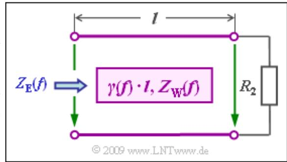
Die Leitung wird mit einer Spannungsquelle mit dem Innenwiderstand  $R_1 = 100 \Omega$  gespeist und ist mit dem Widerstand  $R_2$  abgeschlossen. Der Eingangswiderstand der Leitung ergibt sich zu
